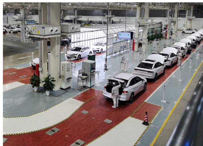
廣汽埃安智慧生態工廠總裝檢查線
